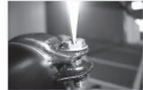
スパナ使用可能なねじを、緩め始め本締め増し締めでドライバー使用（バリが立つ、ねじ頭をつぶす原因）
